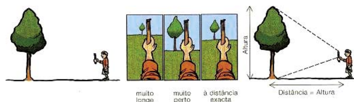
Figura 19 – Para calcular a altura da árvore utilizando um pau, com o braço bem esticado e o pau na vertical, procurar a distância na qual a árvore tem exactamente o mesmo tamanho do que o pau. Marcar o sítio e medir a distância até à árvore (pode ser em passos). Essa é a altura da árvore (fonte: DGRE, Caderno da floresta, 2005)
